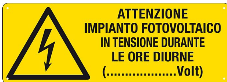
Figura 1– Cartello di segnalazione della presenza di un generatore fotovoltaico
